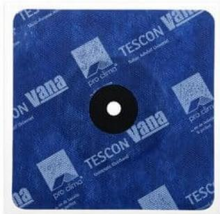
APPLICATION : Manchettes d'étanchéité en EPDM robuste et extrêmement flexible. Optimales pour la réalisation rapide et durablement étanche des passages de câbles et conduits à travers la couche d'étanchéité à l'air. S'utilisent également à l'extérieur, par exemple sur les écrans de sous-toitures ou les frein-vapeurs de rénovation.
